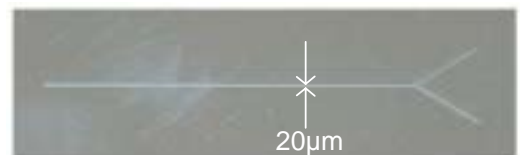
プラスチック基盤上に任意の流路をレーザー加工にて設計 上図・・・流路幅20µmで加工
